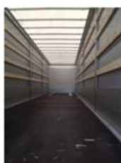
сдвижной тент алюминиевые борта деревянные перекладки
